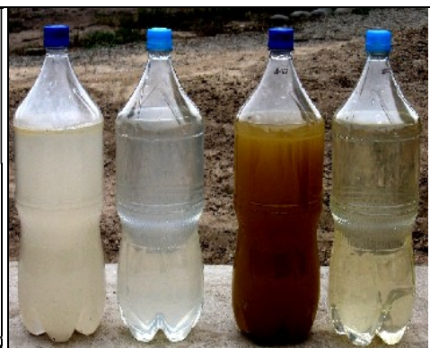
Figura 6: (esquerda - direita): Água cinza bruta e tratada no wetland 1, Água negra bruta e tratada no wetland 2
