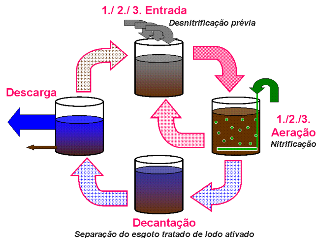
Figura 1: Esquema do funcionamento do reator em batelada seqüencial
