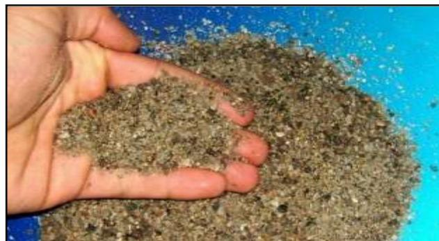
Figura 7. Ejemplo del material utilizado en filtro del HA FSS para el tratamiento de aguas residuales de una comunidad en Brasil, arena gruesa del río sin ningún tipo de arcilla, ni limo (Fuente: C. Platzer, Rotaria do Brasil, 2008)
