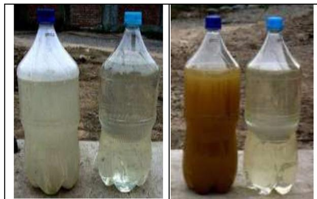
Figura 19 a/b (a) Agua gris pre-tratada y efluente después del HFV, para ser reutilizado en el riego de cultivos, (b) Agua negra pre-tratada y efluente después del HFV, para ser reutilizado en el riego de áreas verdes, las aguas residuales con coloración marrón son típicas y es causado por las huminas (fuentes: H. Hoffmann, 2008)
